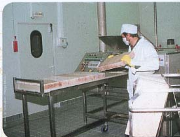
Tunnel de tempérage par micro-ondes. Puissance : 24 kw micro-ondes Cadence : 500 kg/h
